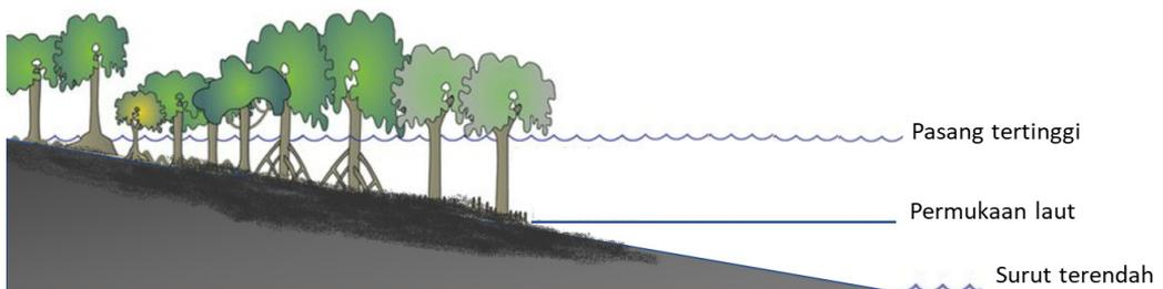
**Gambar 24** Elevasi substrat relatif terhadap selisih pasang tertinggi dan elevasi permukaan air laut rerata (0 mdpl), tempat mangrove tumbuh dengan baik, salah satu aspek penting yang perlu diperhatikan dalam rehabilitasi mangrove
